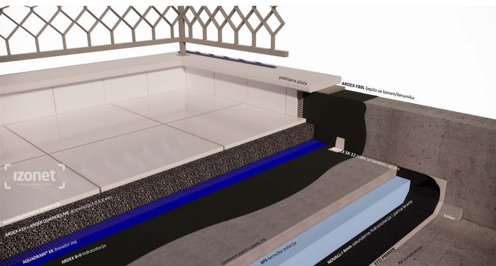
AquaDrain® EK je drenažni sistem posebno napravljen za polaganje vanjskih obloga na drenažni malter (ARDEX A10 + ARDEX QUARKIES ME granulacije 3.0 - 5.6 mm).
